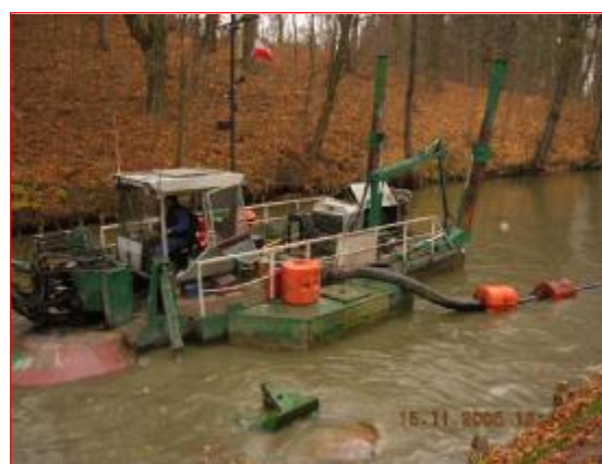
Prace pogłębiająco - odmulające prowadzone są metodą ssąco - refulującą, przy pomocy specjalistycznej pływającej pogłębiarki.
