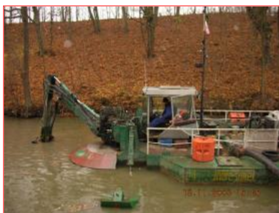
Prace pogłębiająco - odmulające prowadzone są metodą ssąco - refulującą, przy pomocy specjalistycznej pływającej pogłębiarki.
